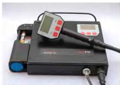
รูปที่ 10 แสดงตัวอย่างเครื่องตรวจวัดระดับสารระเหยอินทรีย์ชนิดเฟรมไอออนไนส์เซนซอร์ (Frame Ionization Detector: FID)
