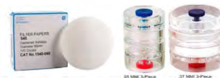
รูปที่ 8 แสดงตัวอย่างกระดาษกรอง (Cellulose Filter) พร้อมตัวล็อกกรอง (Cassette)
